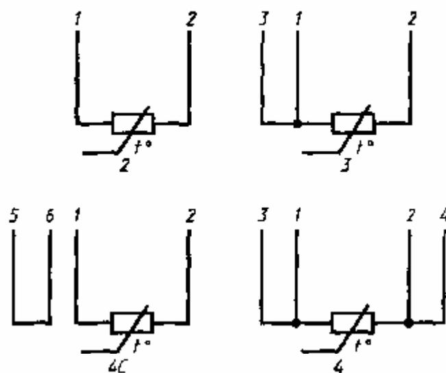
2 — двухпроводная схема; 3 — трехпроводная схема; 4 — четырехпроводная схема; 4С — четырехпроводная схема с комбинацией выводов сопротивления и выводов
