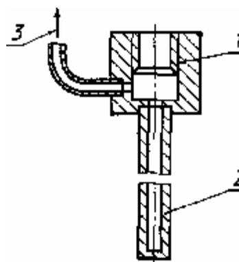
1 — резьба под сальник; 2 — трубка из нержавеющей стали; 3 — к газовому цилиндру или другому источнику давления
