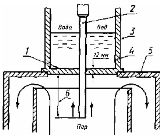
/ — скользящая прокладка для предотвращения утечки воды; 2 — ТС; 3 — контейнер; 4 — основание из пластика; 5 — гипсотермометр; 6 — глубина погружения
