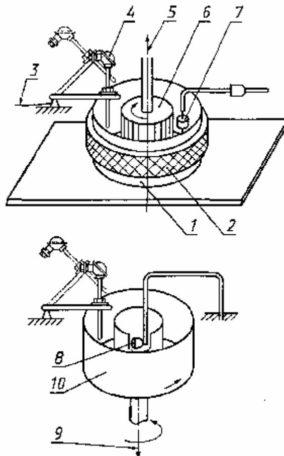
1 — сосуд; 2 — нагревательный элемент; 3 — поворотный рычаг; 4 — ТС; 5 — на приборе с переменной скоростью; 6 — вращающийся барабан; 7 — нагреватель; 8 — инфракрасная лампа; 9 — на приборе с переменной скоростью; 10 — вращающийся сосуд
