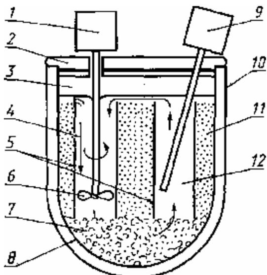
1 — двигатель мешалки; 2 — изолирующая крышка; 3 — металлическая сетка; 4 — направление водного потока; 5 — медная трубка; 6 — крыльчатка; 7 — маленькие кусочки льда; 8 — металлическая сетка; 9 — ТС; 10 — сосуд Дьюара на 5 л; 11 — мелкозернистый лед; 12 — вода при 0 °С
