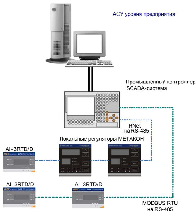
Модули серии MDS обеспечивают периферийный ввод-вывод аналоговых и дискретных сигналов. Модули MDS AI-3RTD и AI-3RTD/D входят в состав серии MDS и имеют 3 независимых канала измерения аналоговых сигналов термопреобразователей сопротивления и по-
